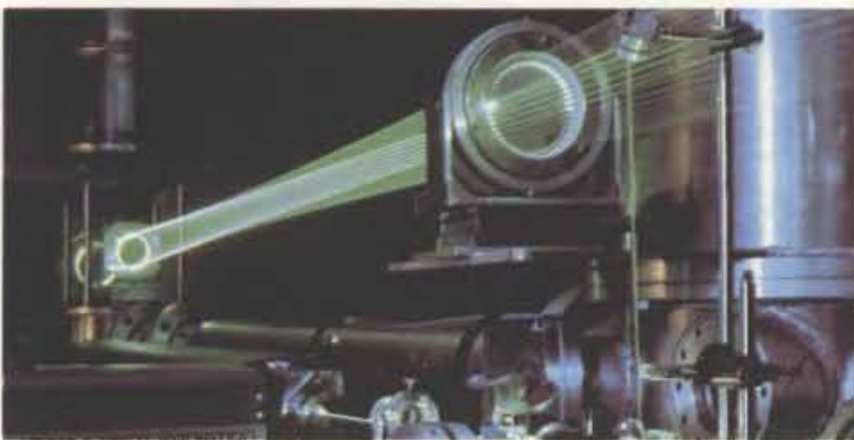
ЛАЗЕРНЫЙ СВЕТ отражается взад-вперед между зеркалами в демонстрационном опыте в установке с линией задержки на 30-метровом интерферометре в Германии.
